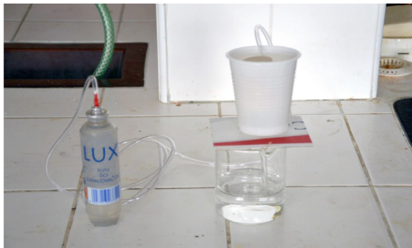
Obrázok 1 Jednoduché prevedenie experimentov interakcie rôznych plynov s pórovitou nádobou (podrobný opis poskytuje Held 2014)
