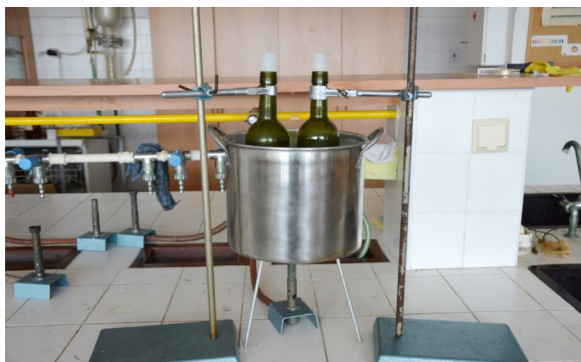
Obrázok 3 Jednoduché prevedenie experimentu indikujúceho Avogadrovu hypotézu nepriamou úvahou: Rozličné plyny pri rovnakých podmienkach (teplota a tlaku) zaberajú rovnaký objem. Pri zmenených podmienkach (teplota) majú opäť rovnaký objem napriek ich rozličnej hmotnosti.
