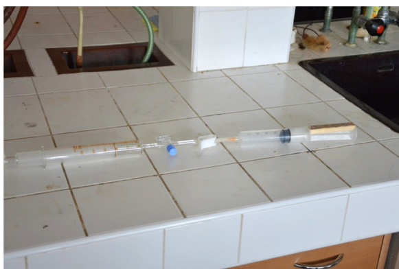
Obrázok 2 Jednoduché prevedenie experimentov sledujúce rýchlosť prúdenia plynov v zobrazenej sústave a súvislosti pohybu mikročastíc s teplom (podrobný opis poskytuje Held 2014)
