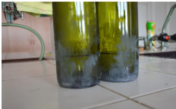
Obrázok 4 Záver jednoduchého experimentu. Rôzne plyny aj po ochladení majú približne rovnaký objem. Výška hladiny vody nasatej do ochladených fliaš indikuje rovnaké zmenšenie objemu.
