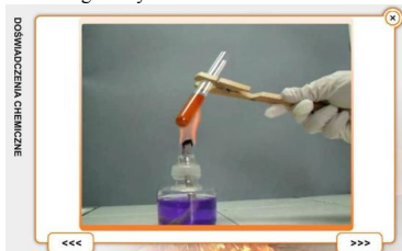
Rys. 11. Reakcja Trommera dla glukozy
