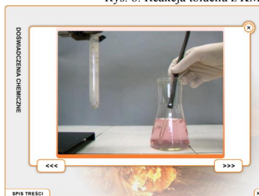
Rys. 9. Reakcja etynu z \text{KMnO}_4 w środowisku obojętnym
