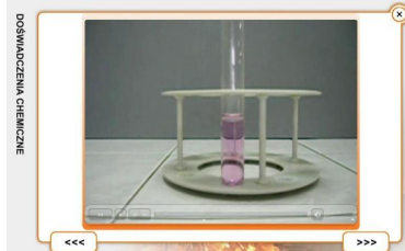
Rys. 8. Reakcja toluenu z \text{KMnO}_{4(aq)} w środowisku kwasowym
