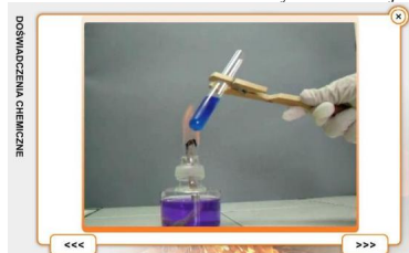
Rys. 11. Reakcja Trommera dla glukozy
