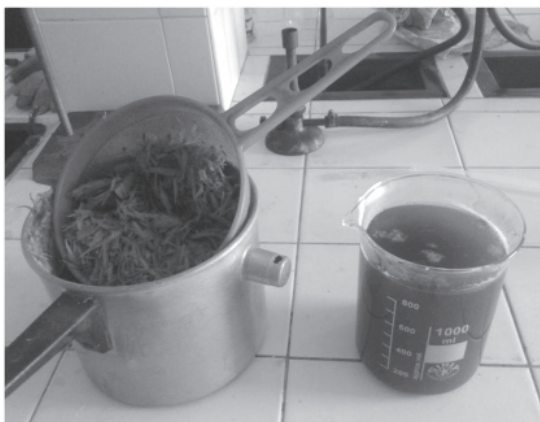
Obrázok 2. Vysladené rezky (vľavo) a difúzna šťava (vpravo)
