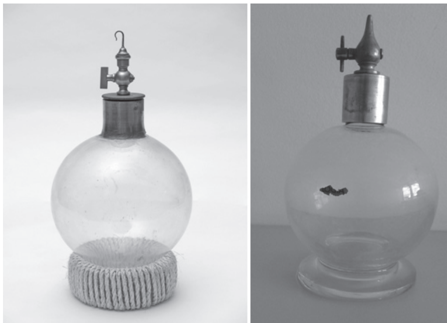
Obrázok 1. Aparatúra na klasické stanovenie molekulovej váhy. Na ľavej strane sa nachádza typická aparatúra z 19. storočia určená na stanovenie hustoty plynov pochádzajúca z Jansen Thomas Apparatus Collection (Oesper Collections), University of Cincinnati, 2015. Na pravej strane je podobná aparatúra zo zbierky autora state
