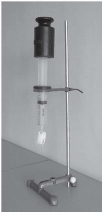
Obrázok 4. Aparatúra určená k „neúspešnej“ falzifikácii Avogadrovej hypotézy
